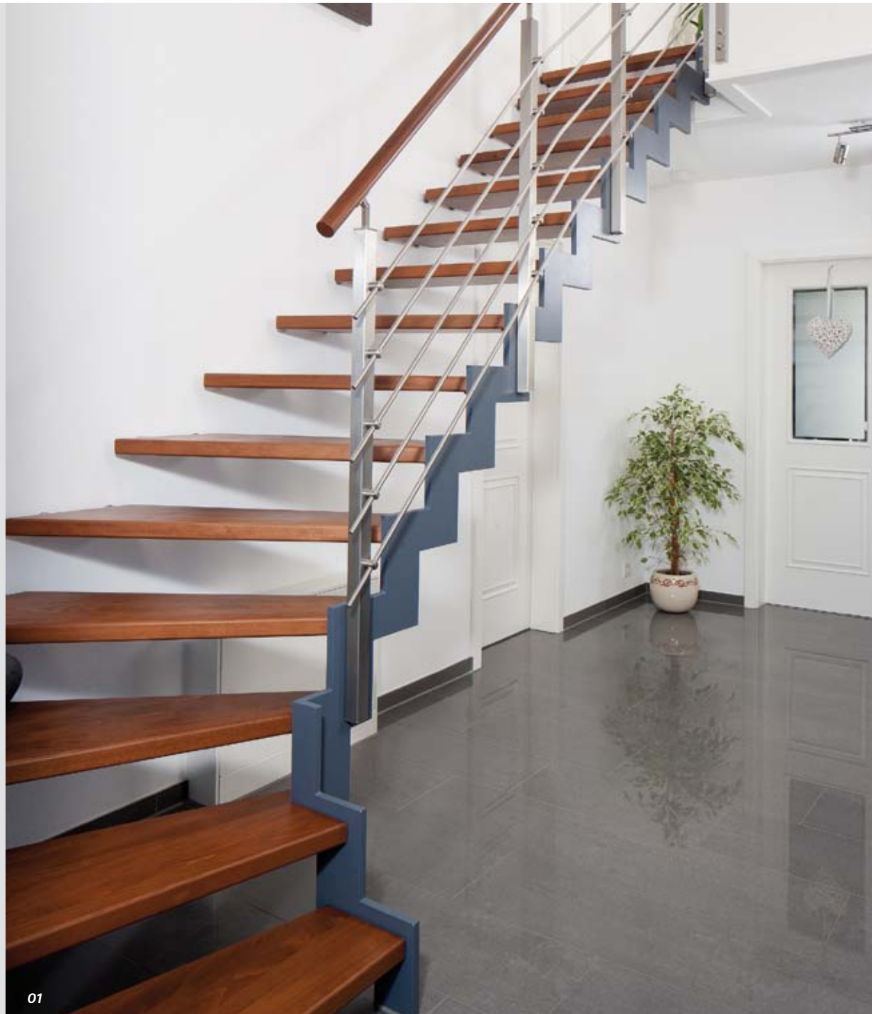
01+03_Freitragende Treppe mit abgetrepter Stahlwange
