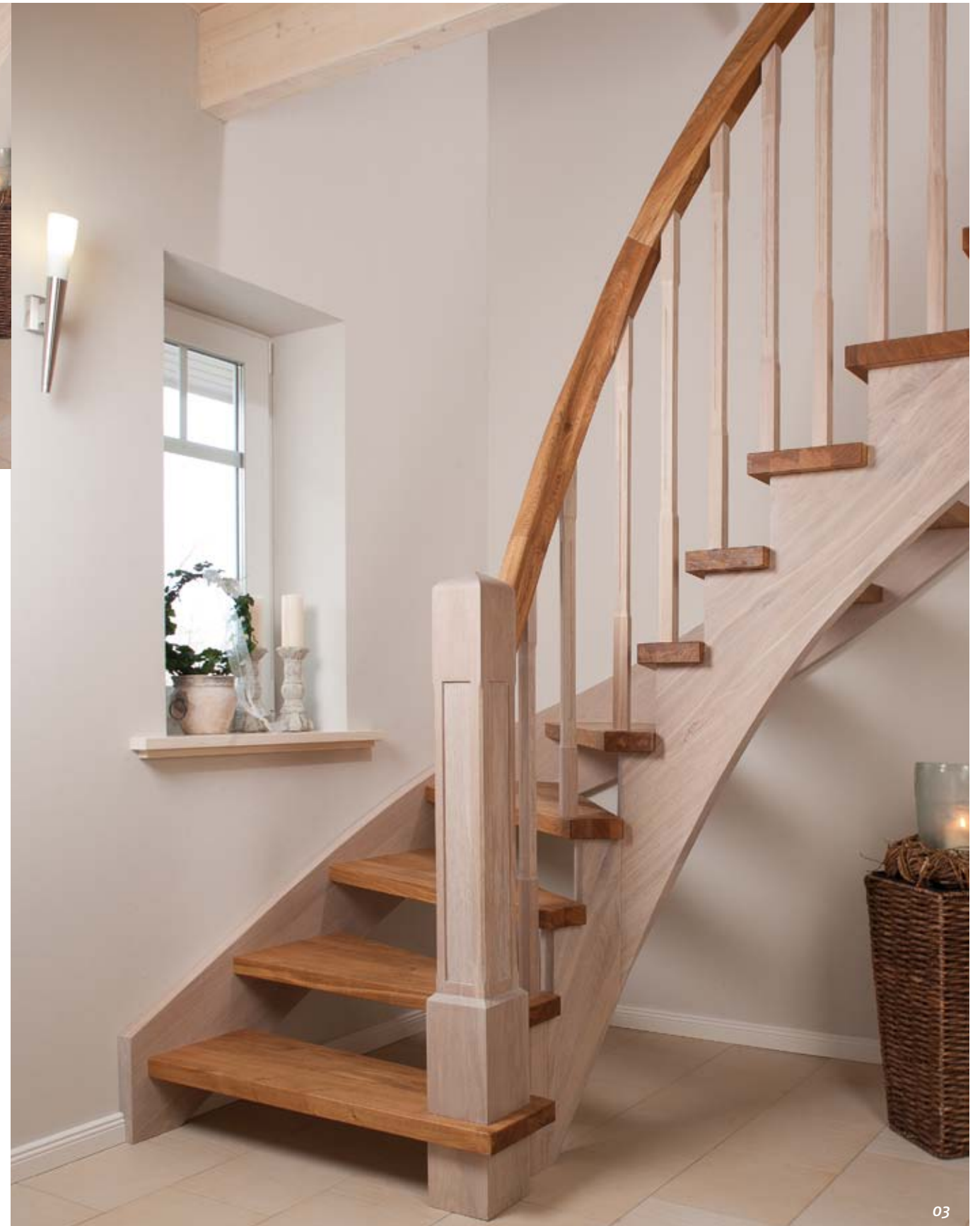
01-03_Wangentreppe wandseitig eingestemmt, freiseitig aufgesattelt, Holzart Eiche astig, Stufen und Handlauf geölt, Stäbe und Pfosten weiß transparent gewachst
